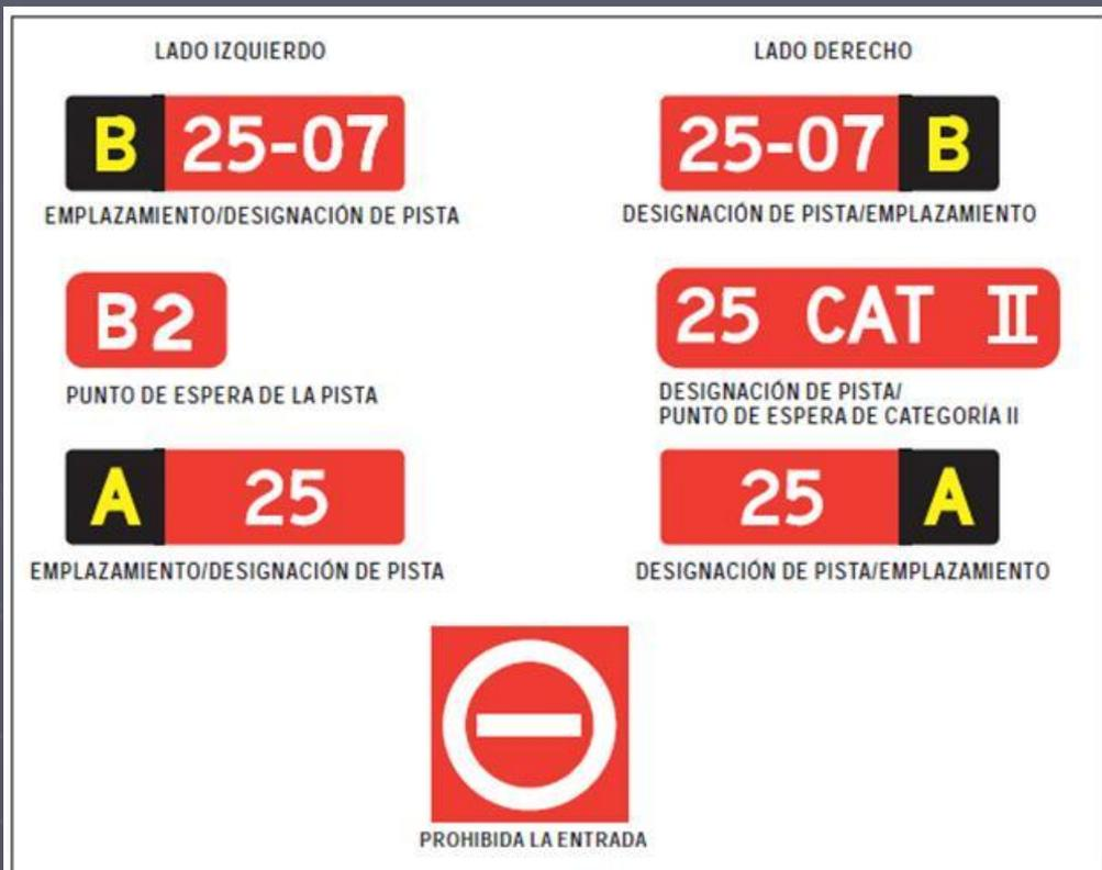
► 5.4.2.3 Las señales de punto de espera de la pista, configuración A, se complementarán con un letrero de designación de pista en la intersección de calle de rodaje/pista o en la intersección de pista/pista.
